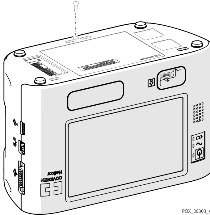
Figure 12-6. Parameter Module Screw Removal
